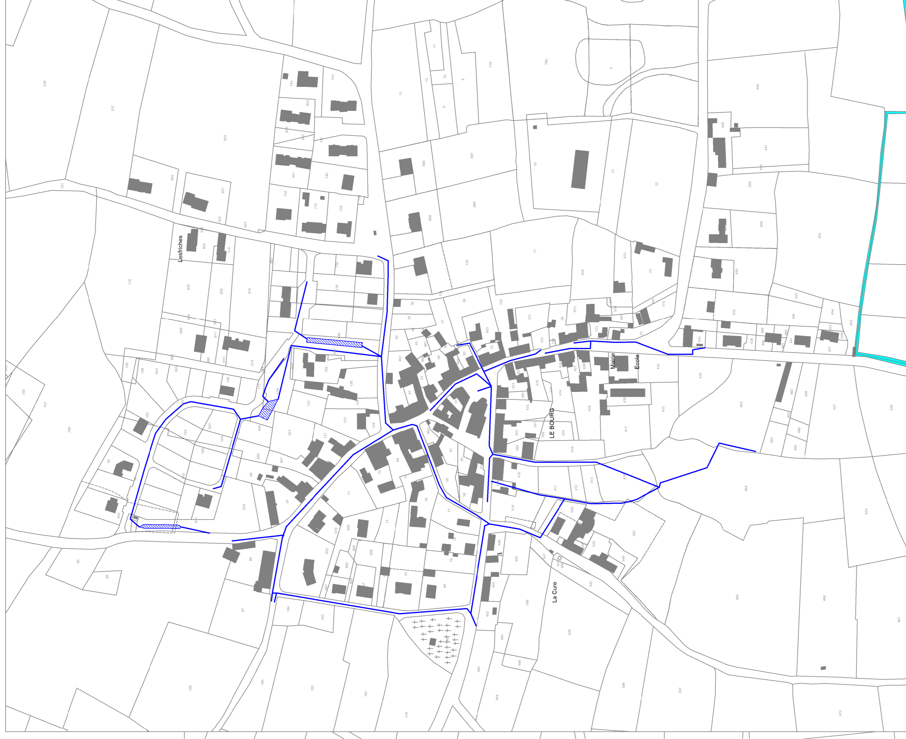
Plan du réseau des eaux pluviales
