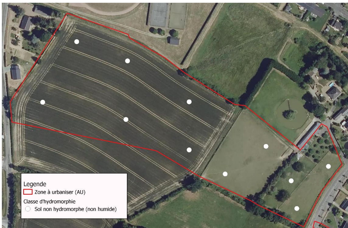
Figure 12 : localisation et résultats des sondages effectués à la tarière
