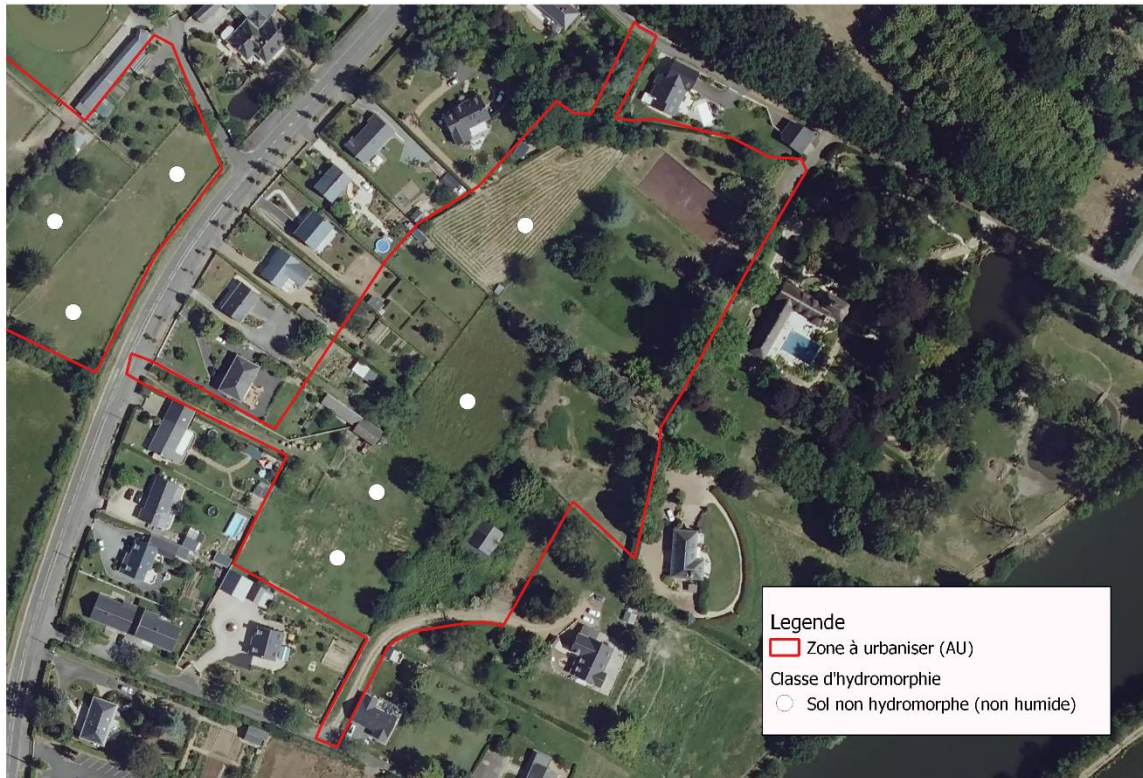
Figure 9 : localisation et résultats des sondages effectués à la tarière
