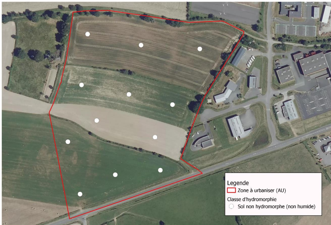
Figure 5 : localisation et résultats des sondages effectués à la tarière
