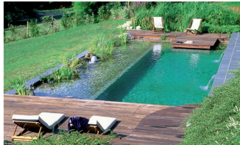
Exemple de piscine avec système d'assainissement par les plantes (phytoépuration)
